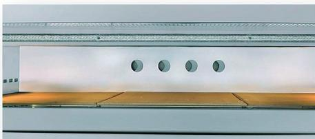
La evacuación de vapores se realiza mediante orificios situados en la pared del fondo de la cámara cuya apertura se controla eléctricamente.
